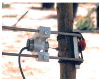
Figura 9. Transductor de grosor instalado en tronco. Evolución diaria de las microvariaciones de grosor de tronco en dos árboles de albaricquero sometidos a regímenes de riego diferentes. Árboles bien regados (círculos cerrados), árboles estresados hídricamente (círculos abiertos). (Ortuño et al. , 2007)
