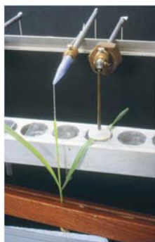
Figura 8. Uso de los transductores de grosor para medir simultáneamente el crecimiento y el turgor/grosor foliar en una planta de trigo sometida a shock osmótico (80 mM NaCl). La disminución de los valores en ambos parámetros a nivel foliar ante la aplicación de sales en la raíz demuestra la participación de señales hidráulicas en este tipo de estrés (Alarcón y Malone, 1995c).
