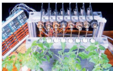
Figura 7. Batería de transductores midiendo variaciones de grosor en hojas de tomate Esquema del uso de los transductores de grosor foliar para medir la transmisión de señales hidráulicas desde el lugar donde se produce el daño mecánico hasta hojas distantes de la planta.
