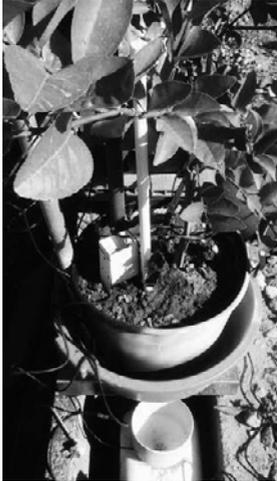
*Foto 1:* Detalle de la macetas-lisímetros de limeros Bearss instrumentalizadas.
